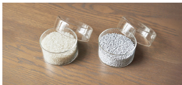
再生プラスチック(左)を80%使用した製品前面パネルのプラスチック(右)
